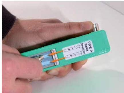
Limpieza mediante cinta
